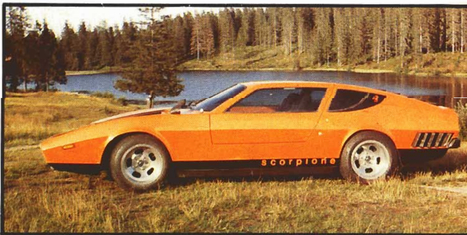
Bilen är låg och har en aerodynamiskt gynnsamt utformad kaross. Luftutsläppet vid bakflyglarna avslöjar att motorn sitter bak.
